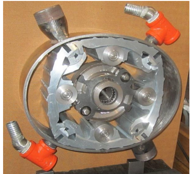
Photo C: Échantillon d'un stator Quasiturbine Réalisé à partir des résultats du calcul
