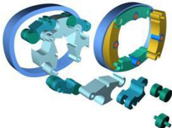
Photo A – La Quasiturbine « QT » avec disposition des rotors à chariots www.quasiturbine.com basée sur une conception de fabrication optionnelle.
